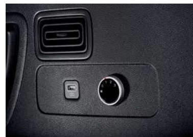
Ventilaciones de aire acondicionado de la 3ª fila con control de velocidad (3 etapas)
